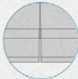
Retrait sur le pied afin de faciliter la pose et l'alignement des faces
