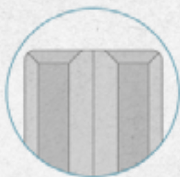
Chanfreins arrondis sur la face supérieure du mur
